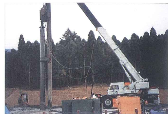
地熱・石油井 地熱・石油井の地表から50m程度の深さの口元掘削に使用されています。
